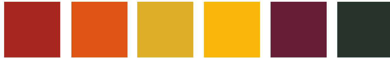
RAL 3000 Rot / Red / Rouge RAL 2009 Orange / Orange / Orange RAL 1012 Zitronengelb / Lemon yellow / Jaune citron RAL 1023 Gelb / Yellow / Jaune RAL 4004 Bordeauxviolet / Claret violet / Violet bordeaux RAL 6009 Tannengrün / Fir green / Vert sapin
